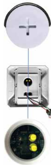
Abbildung 8 Vergrößerte Ansicht des Bindsteckers oben und der Drehschalter S1, S2 unten
