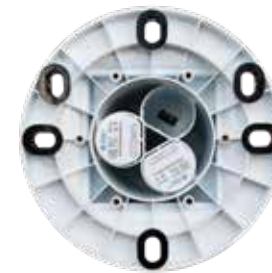
Abbildung 4 Batteriefach mit zwei Akkus
